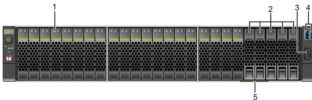
图 4-3 8x2.5 SAS/SATA+12x2.5 NVMe 硬盘配置前面板组件
